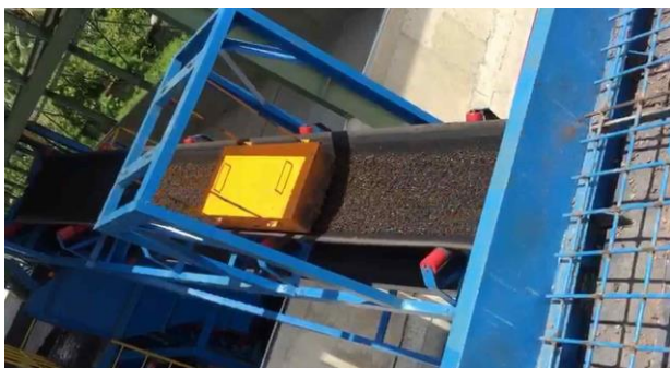
③ 1回目精練後、金属探知機に掛けて次の工程へ
