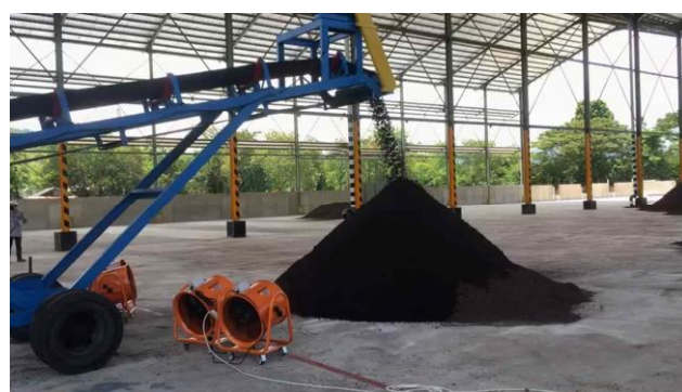
⑥ コンベアーの落差を利用し、強力風力機で、ファイバー・粉じん等を飛ばし、保管ヤードへ
