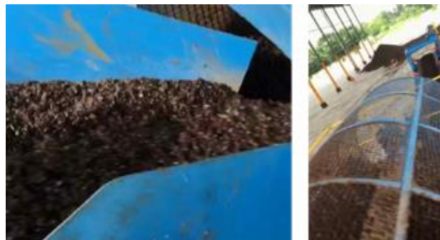
⑤ 2回目精練後、細かいゴミや粉等を回転式篩機で排除し、自然風乾燥
